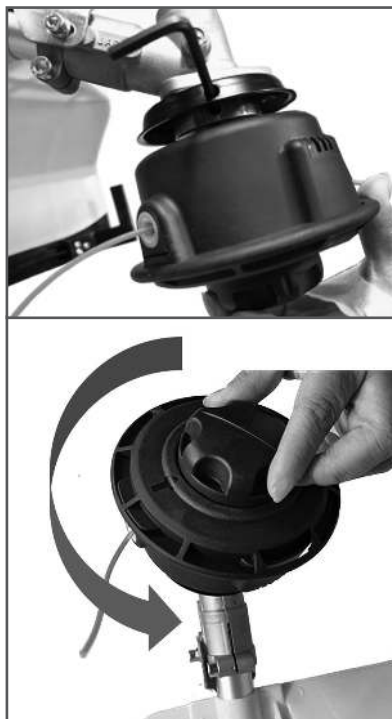
Рис. 5 Установка триммерной головки
