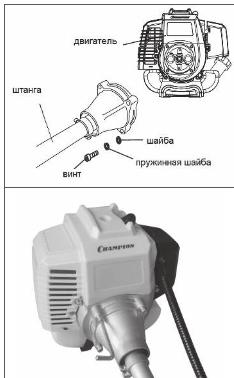
Рис. 6 Соединение двигателя и штанги
