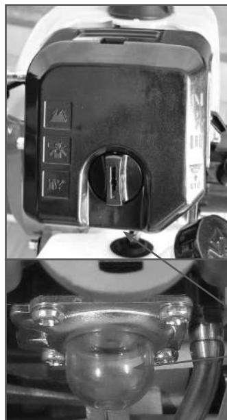
Рис. 10 Расположение ручного топливного насоса
