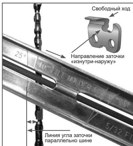
Рис. 16 Определение угла заточки
