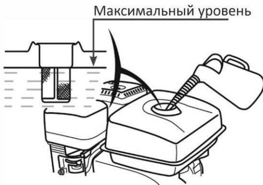
Рис. 8. Определение максимального уровня топлива в баке.
