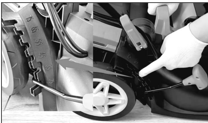
Рис. 7 Механизм регулирования высоты кошения у модели ELM2400
