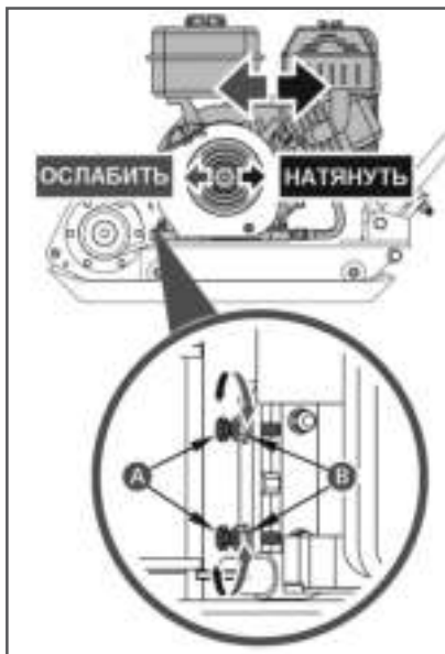
Рис. 26 Регулировка натяжения ремней А – болт В - контргайка
