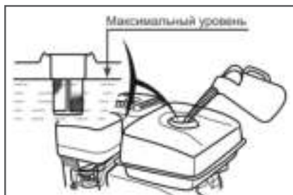
Рис. 11 Максимальный уровень топлива в топливном баке
