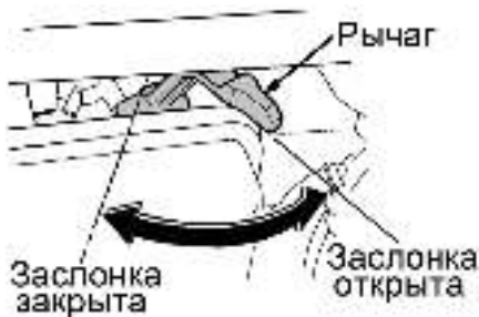
Рис. 11 Рычаг управления воздушной заслонкой
