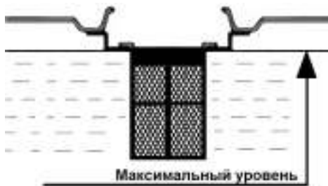
Рис. 10 Максимальный уровень топлива в топливном баке
