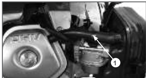
Рис. 15 Трубка системы вентиляции картера
