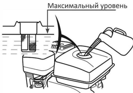
Рис. 5. Определение максимального уровня топлива в баке.
