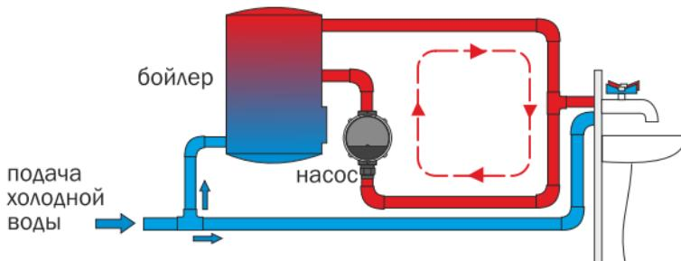
Насос устанавливается только в системах ГВС частных домов, коттеджей, квартир и общественных зданий. Никакой другой области применения данного насоса не предусмотрено. Насос предназначен для постоянной бесперебойной эксплуатации.
