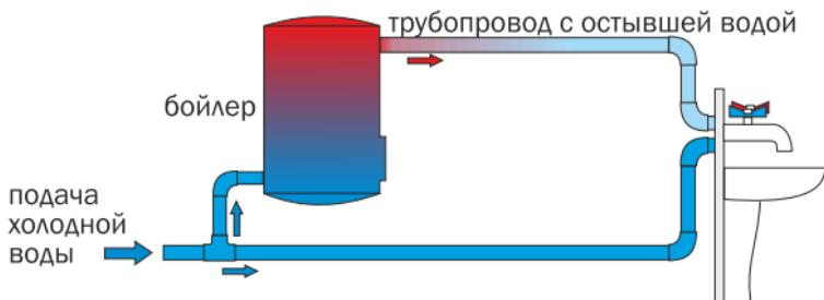
*Система горячего водоснабжения с насосом*
