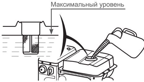
Рис. 28 Максимальный уровень топлива в топливном баке
