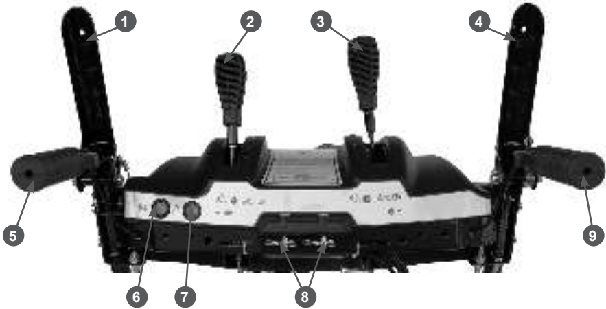
Рис. 2 Панель управления (вид со стороны оператора)
