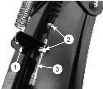
Рис. 21 Установка оболочки троса управления дефлектором жёлоба
