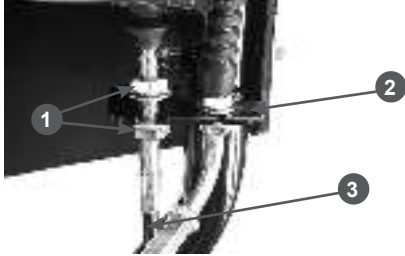
Рис. 10 Крепление оболочки троса включения хода
