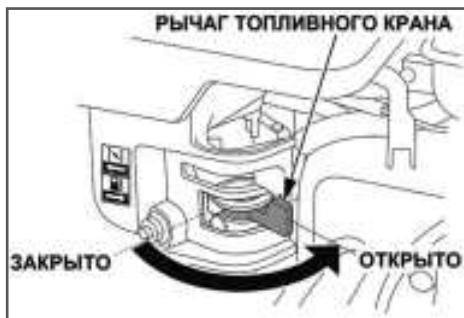
Рис. 10 Топливный кран открыт
