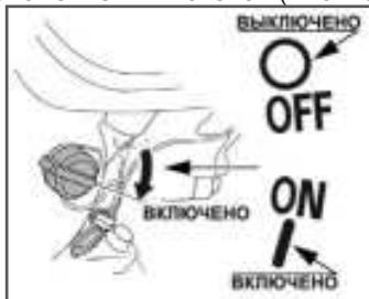
Рис. 13 Выключатель зажигания в положении «Включено»
