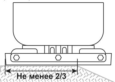
Рис. 14 Расположение виброплиты на краю обрабатываемой поверхности
