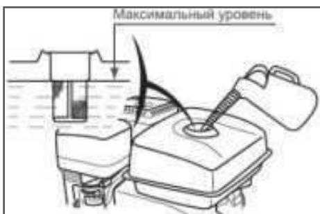
Рис. 7 Максимальный уровень топлива в топливном баке
