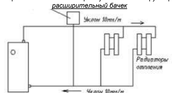
Рис.1. Схема монтажа открытой системы отопления
