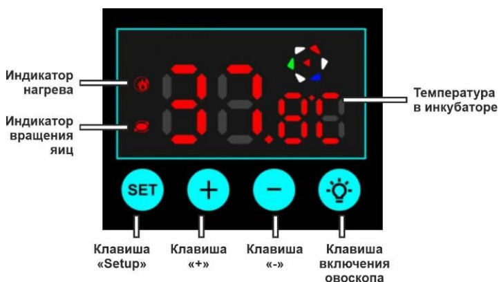
Рис. 8. Панель управления режимами инкубации.
