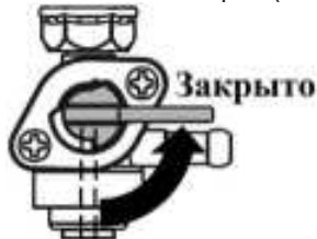
Рис. 7 Топливный кран закрыт
