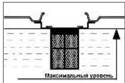
Рис. 7 Максимальный уровень топлива в топливном баке
