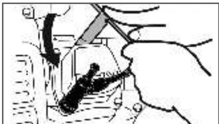
Рис. 26 Обслуживание свечи зажигания
