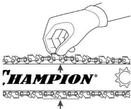
Рис. 5 Проверка натяжения цепи
