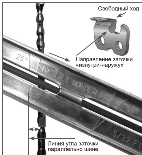
Рис. 17 Определение угла заточки
