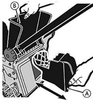
Рис. 15 Установка заглушки для мульчирования
