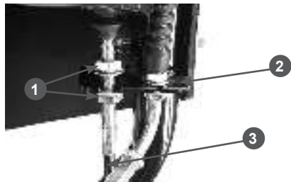
Рис. 11 Крепление оболочки троса включения хода
