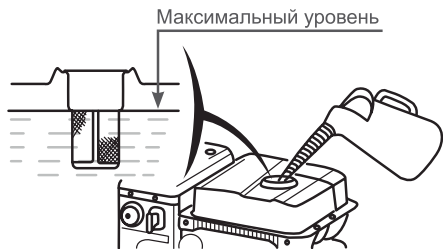
Рис. 31 Максимальный уровень топлива в топливном баке
