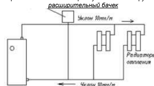
Рис.1. Схема монтажа открытой системы отопления
