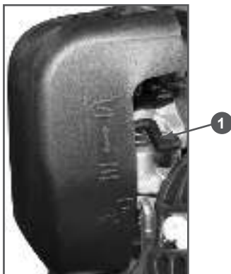
Рис. 9 Расположение воздушной заслонки
