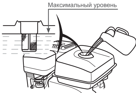
Рис. 14 Максимальный уровень топлива в топливном баке
