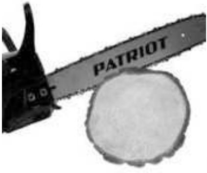
Не стоит прилагать усилия при распиловке древесины, собственный вес пилы позволяет вести процесс распиловки. Если цепь зажало, остановите двигатель, приподнимите или измените положение бревна. Не стоит дергать инструментом для освобождения цепи.
