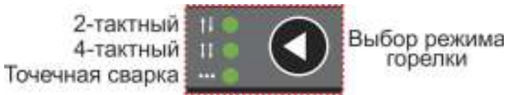
Рисунок 10-5. Переключение параметров сварки.
