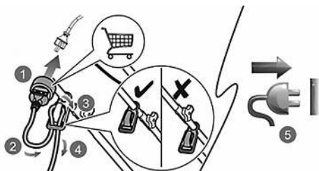
Рис. 9 Фиксация кабеля удлинителя на рабочей рукоятке
