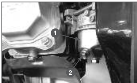
Рис. 21 Слив топлива из карбюратора
