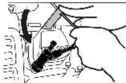
Рис. 22 Обслуживание свечи зажигания
