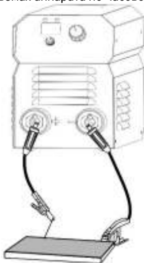
Постоянный ток обратной полярности: «+» на электроде
