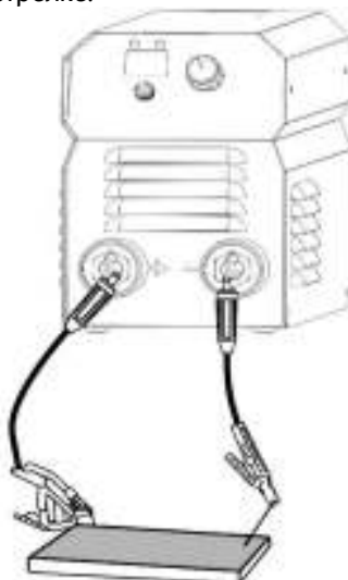
Постоянный ток прямой полярности: «-» на электроде
