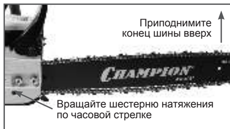
Рис. 5 Регулировка натяжения цепи
