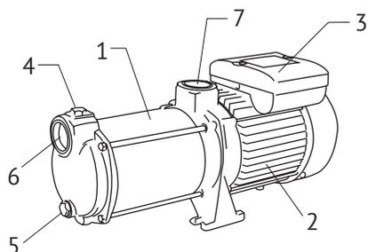
Насос состоит из гидравлической части (1), асинхронного электродвигателя (2) и блока подключения с пусковым конденсатором (3).
