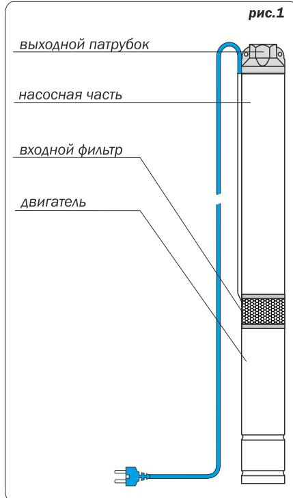
Технические характеристики указаны на идентификационной табличке, расположенной на корпусе насоса, и в таблице 1. Компания Aquario оставляет за собой право незначительно изменять конструкцию и технические параметры оборудования без предварительного уведомления.
