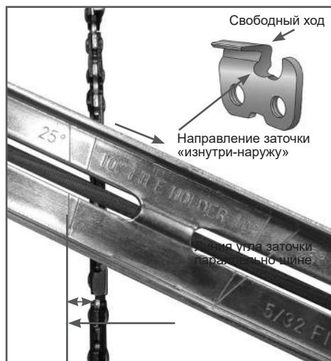
Рис. 22 Расположение линии угла заточки
