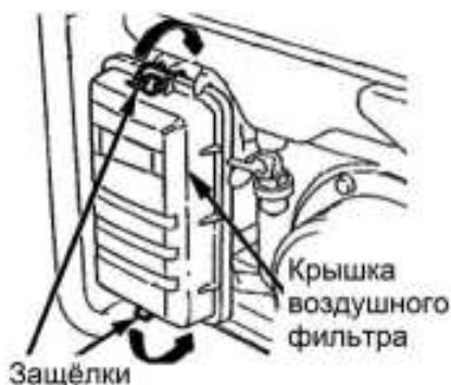
Рис. 14 Снятие крышки воздушного фильтра
