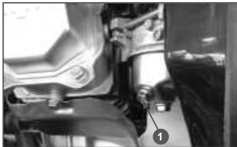
Рис. 20 Слив топлива из карбюратора 1. Болт сливной
