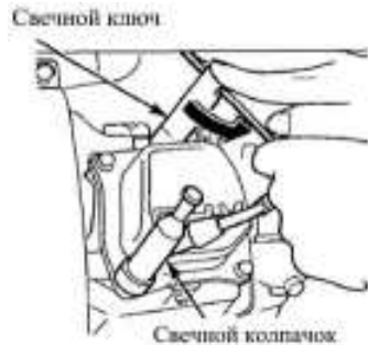
Рис.18 Обслуживание свечи зажигания
