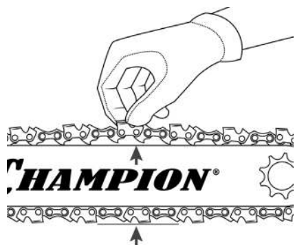
Рис. 4 Проверка натяжения цепи
