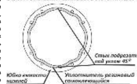
СХЕМА УСТАНОВКИ РЕЗИНОВОГО УПЛОТНИТЕЛЯ
