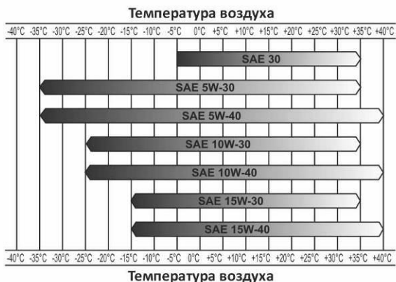
Рис. 6. Определение марки масла в зависимости от температуры воздуха
