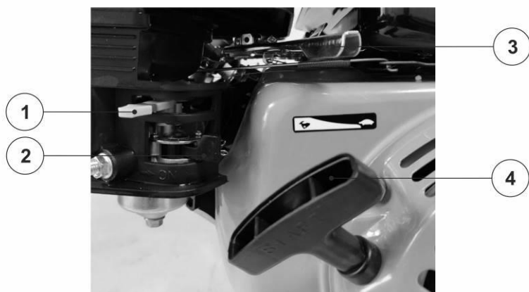
Рис. 4. Органы управления двигателя у моделей HT-WP20, HT-WP30, HT-80S 1. Рычаг воздушной заслонки 2. Топливный кран 3. Рычаг газа 4. Ручка стартера
