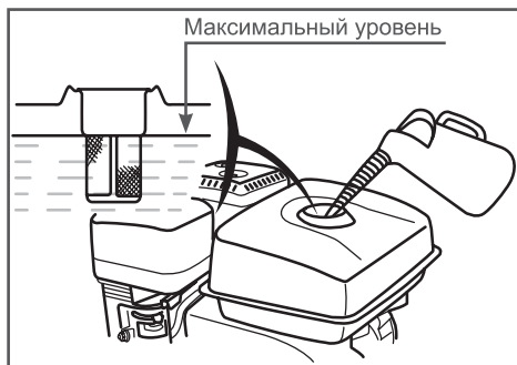
Рис. 24. Максимальный уровень топлива в топливном баке
