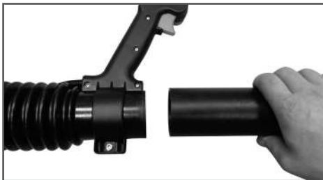
Рис. 5 Установка трубы напорной
