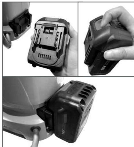
Рис. 4. Установка аккумулятора для модели SA10K
